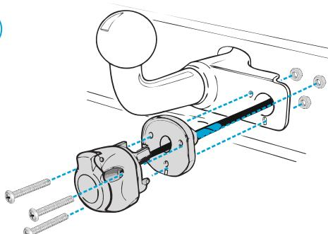
Герметично заизолируйте соединение между пыльником и жгутом провода розетки.
