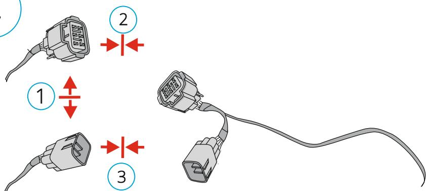
Соедините колодки до щелчка, в порядке, указанном на рисунке, надежно закрепите.
