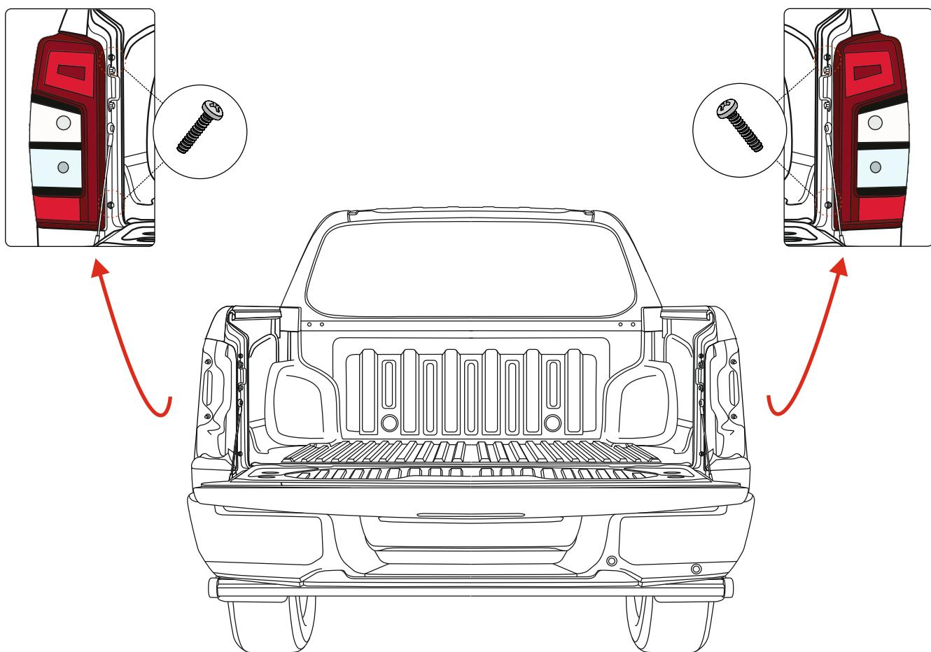
Элементы обшивки, которые рекомендуем демонтировать перед установкой комплекта проводки.
