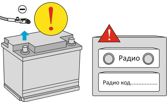
При несоблюдении данного требования блоки управления электрической системой транспортного средства могут быть повреждены или выведены из строя!
